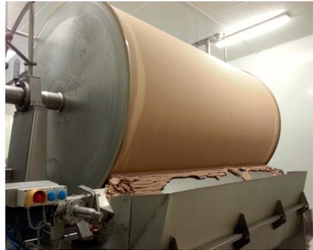
*Vakuumb-Drehfilter, Vorder- und Rückseite (v.l.n.r.)*
